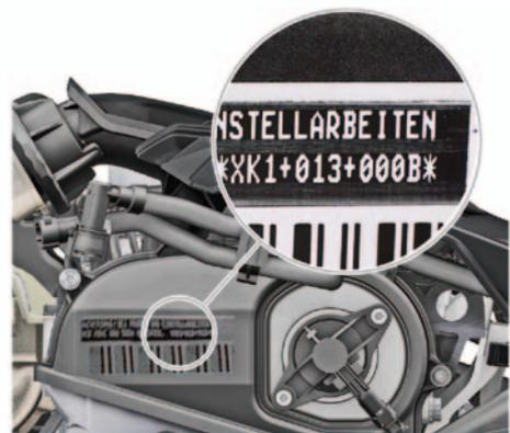
Protection de courroie crantée avec code XK-1
